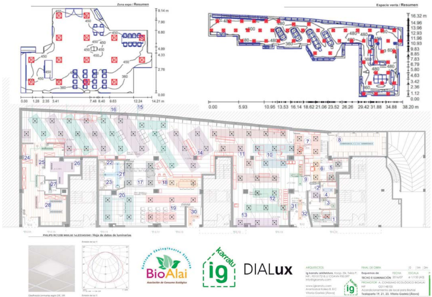
Figura 5. Estudio de iluminación con dialux y resumen de encendidos .
